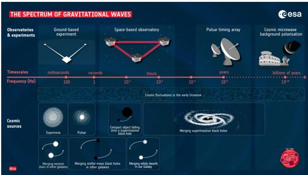
Спектр гравитационных волн. По горизонтальной оси указаны период и соответствующая частота волны. Вверху изображены гравитационно-волновые детекторы, предназначенные для исследования волн с разными характеристиками. Внизу показаны возможные источники этих волн. Рисунок с сайта [esa.int](http://esa.int)
