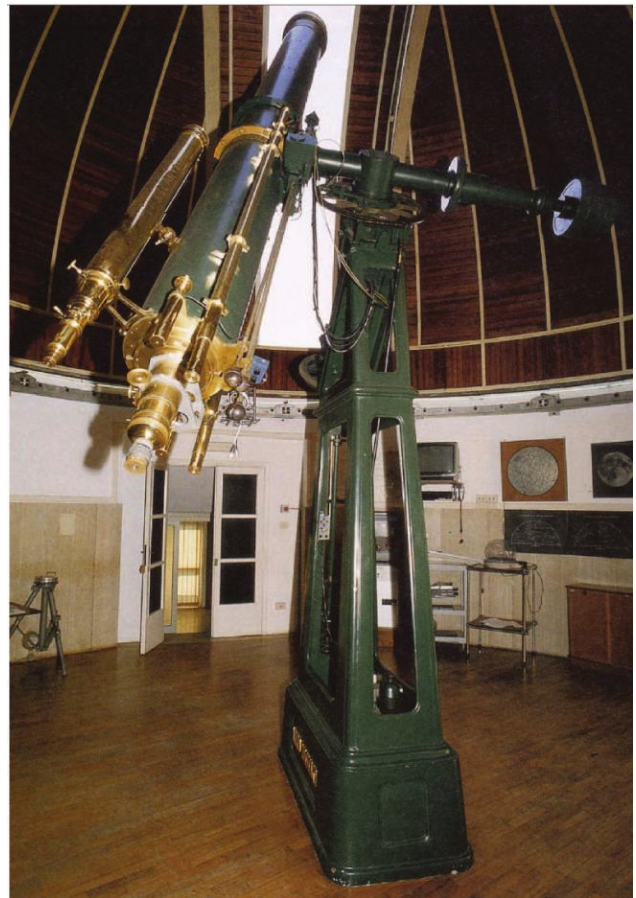
Рис. 3. 11-дюймовый телескоп Амичи.
