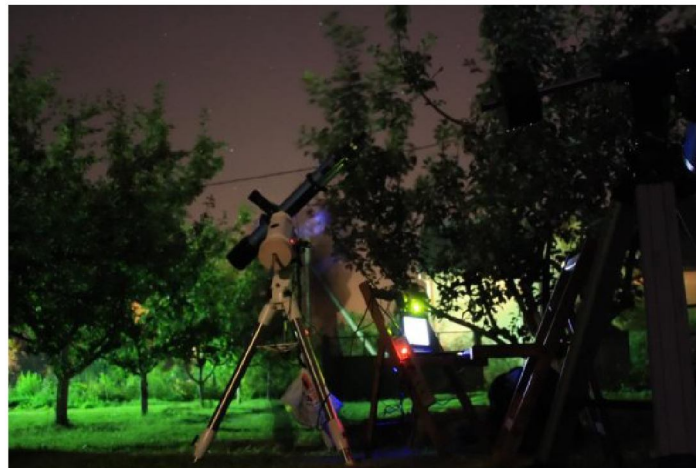
Установка astronominsk'a для фотографирования объектов глубокого космоса – монтировка EQ6, на ней ахромат, к которому крепится Canon 300Da с объективом Юпитер-37А и H-alpha фильтром Orion 7 nm. Canon EOS 1000D, экспозиция 21 с.
