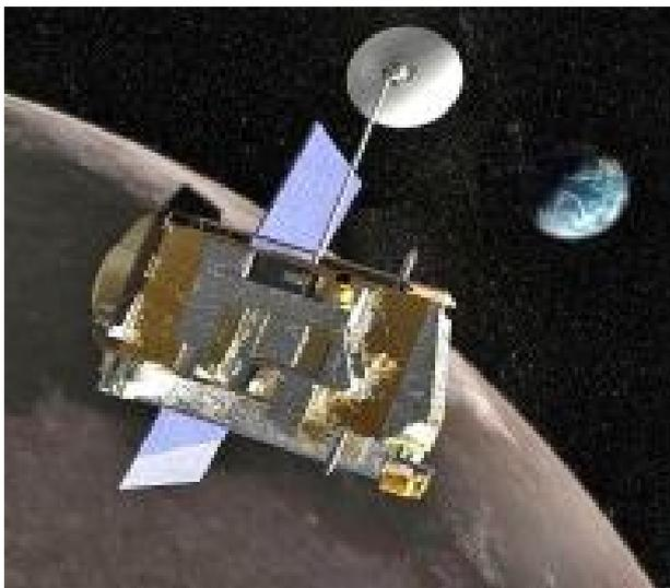
DLRE (The Diviner Lunar Radiometer Experiment) — измерение теплового излучения лунной поверхности и его изменения в течении суток, информация нужна для будущих работ на поверхности Луны.
