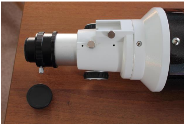
Типовой штатный фокусёр рефракторов Sky Watcher и Celestron OMNI.
