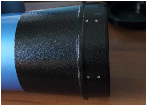
Оправа объектива рефрактора SW15075 с двенадцатью винтами (по шесть на каждую линзу), винты расположены друг над другом.
