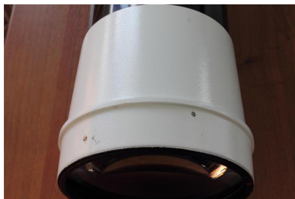
Оправа объектива рефрактора SW15075 с шестью юстировочными винтами (три на каждую линзу), разнесёнными на 60°.
